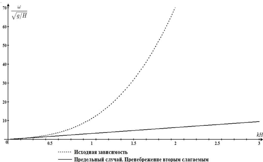
Рис. 2. Зависимость частоты от волнового вектора для системы уравнений Грина–Нагди
